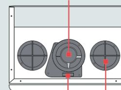
Punto de inspección para análisis de gases de combustión
